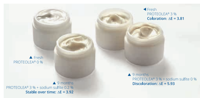
Abb. 4: Färbung und Reifung. Oben rechts: Leichte Färbung einer Emulsion nach Zugabe von 3% PROTEOLEA®; Oben links: Referenzemulsion ohne Wirkstoff; Unten links: Erfolgreiche Farbstabilisierung nach Zugabe von Natriumsulfit nach 9 Monaten Lagerung; Unten rechts: Verfärbung ohne Zugabe von Natriumsulfit nach 9 Monaten Lagerung.
